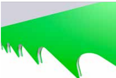
Többélű vágóél Szétdaraboltabb forgács
